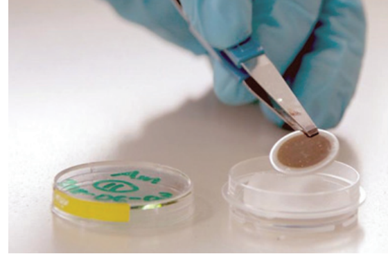
عملية فصل النظائر المشعة كيميائياً لتقدير مستويات المواد المشعة.
