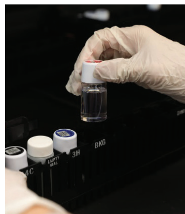
قياس جسيمات ألفا وبيتا بواسطة عداد السائل الوميضي
