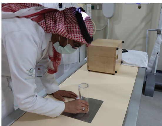
إجراء اختبارات/فحوصات تأكيد الجودة لأجهزة التشخيص الطبي الإشعاعي
