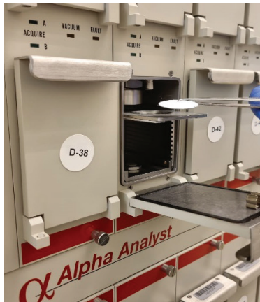
جهاز التحليل الطيفي لجسيمات ألفا
