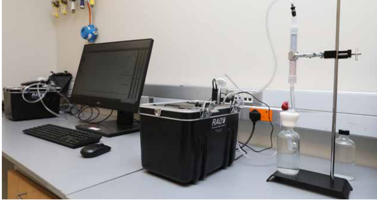
قياس مستوى غاز الرادون المشع في عينات المياه
