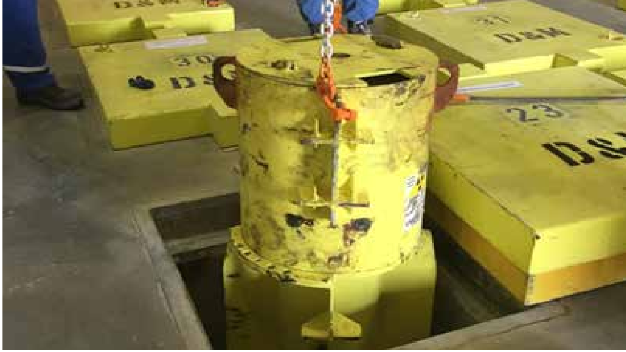
مخزن المصادر المشعة في أحد الممارسات الإشعاعية الصناعية
