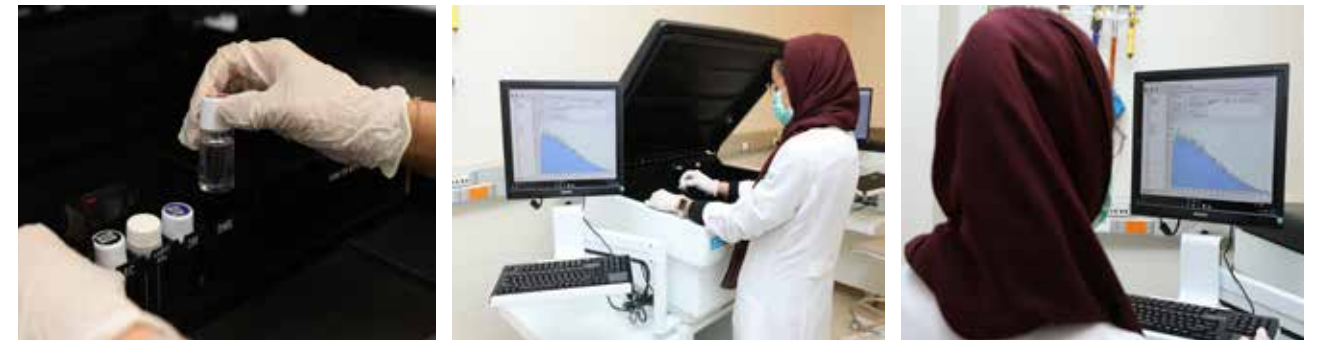
تقنية قياس النشاط الإشعاعي للنظائر منخفضة الطاقة لمشعات ألفا وبيتا
