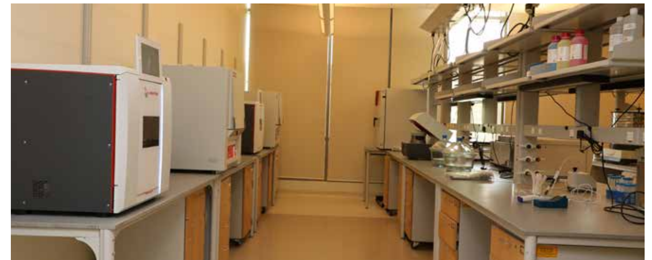
التجهيزات الخاصة بتحضير العينات الإشعاعية للقياس وتشمل أفران حرق العينات وعمليات الفصل الكيميائي للنظائر المشعة
