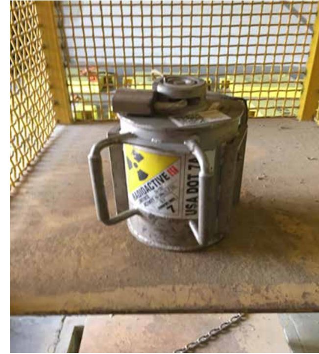
مصدر مشع مدرع، خاص بسبر أغوار الآبار، أثناء إخراجة من المخزن
