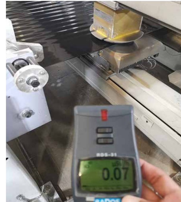
نموذج من أحد الممارسات الإشعاعية الصناعية (أجهزة القياس النووي أثناء التفتيش)
