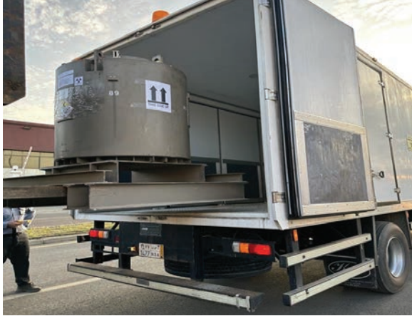
تحميل الحاوية في المركبة المرخصة لنقل المواد المشعة.
