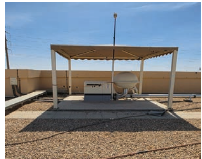
(1) محطة جمع عينات فلتر الهواء بأحجام كبيرة.
