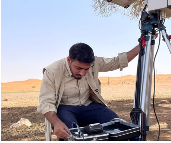
قياس معدل الجرعة الإشعاعية وغاز الرادون في الموقع
