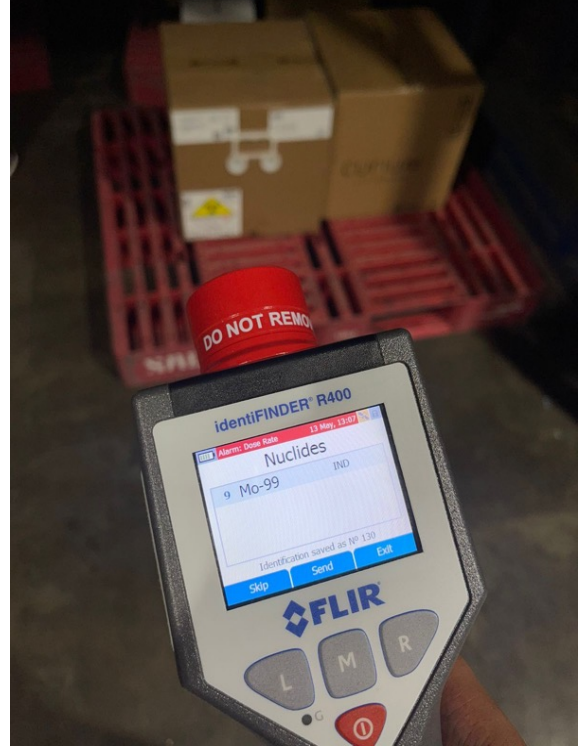
مثال لمعاينة مصادر مشعة باستخدام أجهزة القياس الإشعاعي
