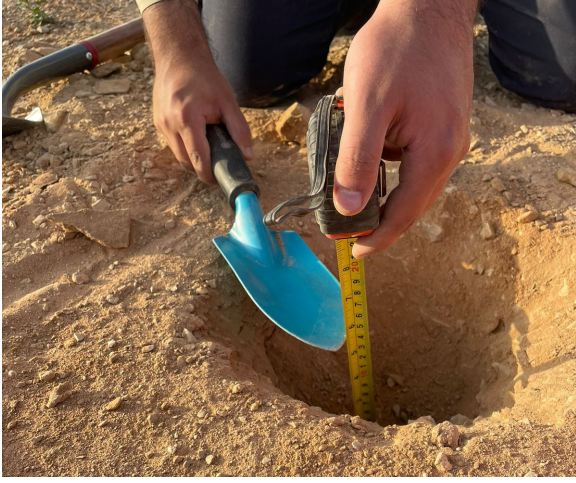
قياس العمق وأخذ عينات التربة السطحية وتحت السطحية
