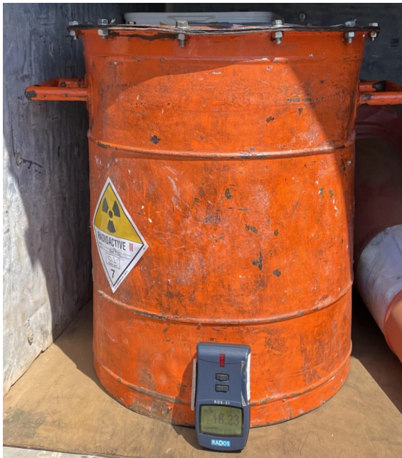
أمثلة على أنواع تغليف مختلفة لبعض الشحنات التي تحتوي على مواد مشعة
