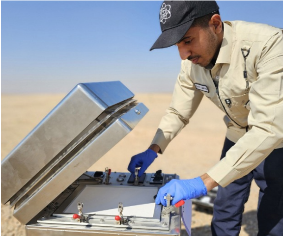
عملية جمع فلاتر الهواء لتقدير الملوثات المشعة في الهواء
